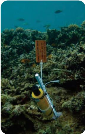
Déploiement d'une sonde TD température/pression
