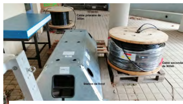
Matériel d'acquisition de données prévus d'être immergés à la bouée SOLA
