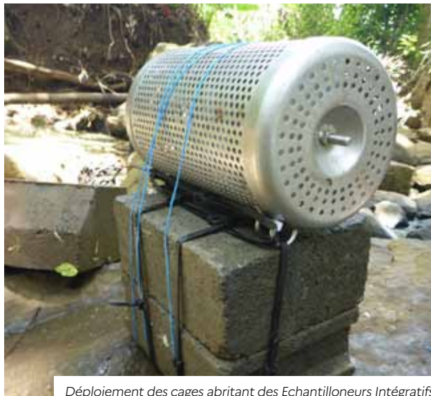
Déploiement des cages abritant des Echantillonneurs Intégratifs Passifs dans un cours d'eau.
