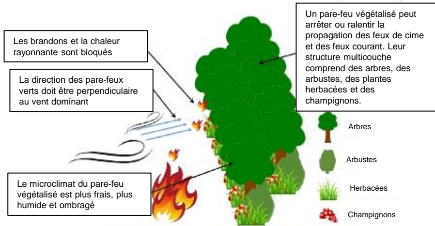
Fig. 3. Mécanismes par lesquels les pare-feux végétalisés contribuent à la maîtrise des incendies
