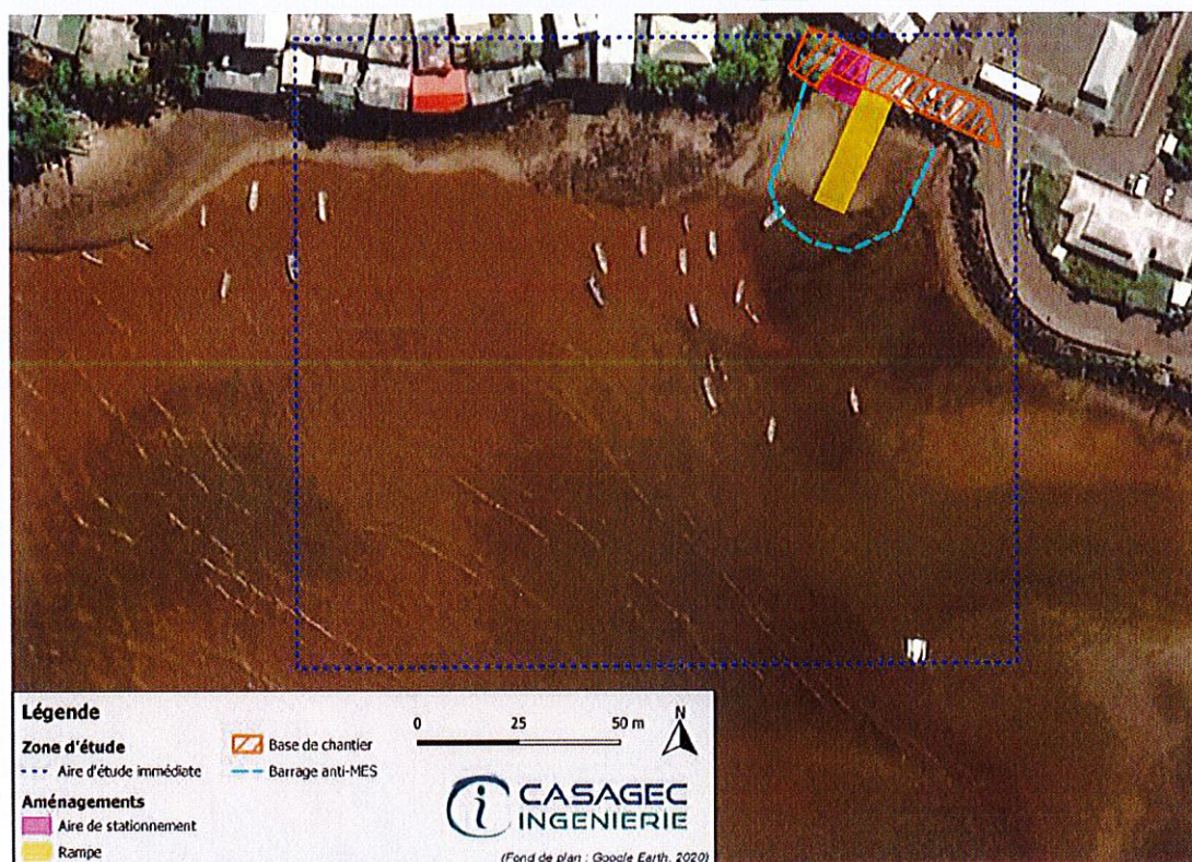
Figure 12 : Localisation de la base de chantier et du barrage anti-MES.
