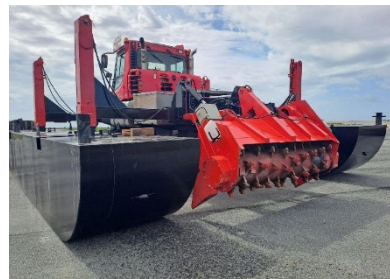
Nouveau prototype de machine pour broyer les récifs d'huîtres sauvages réalisé par l'entreprise SAS CTAT RNN BA / OFB - LPO
