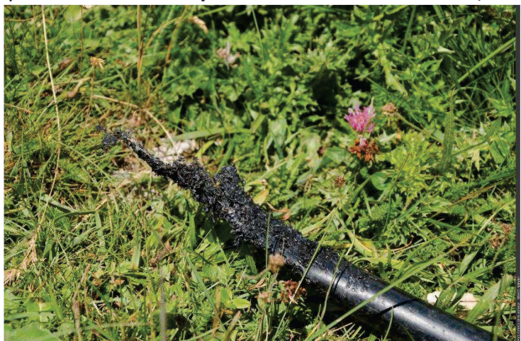
Fig. 11 : exemple de câble rongé par une marmotte ; Nathalie Tissot
