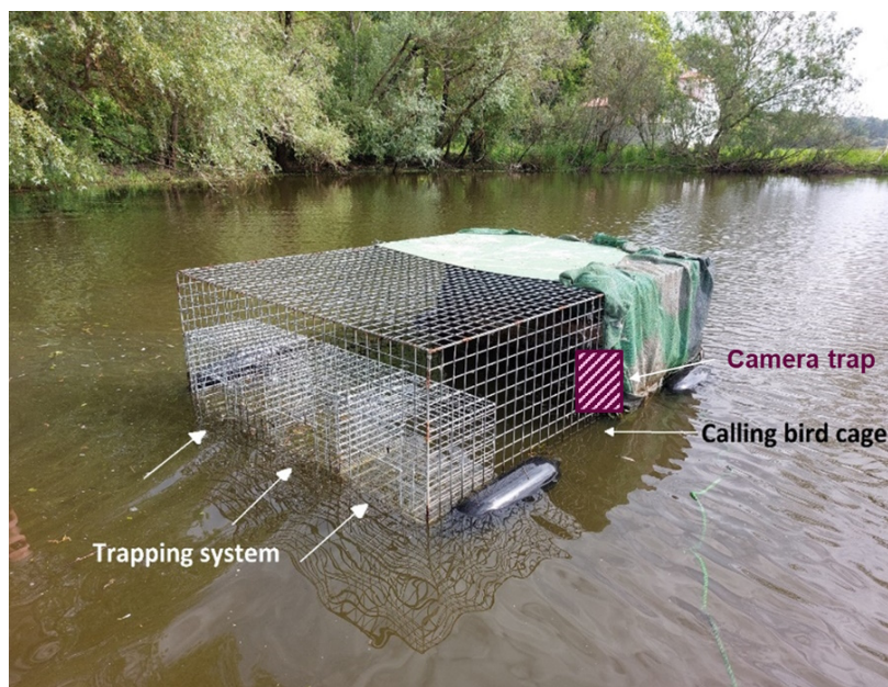
FIGURE 9 : Second prototype avec son système de suivi à distance des captures © OFB
