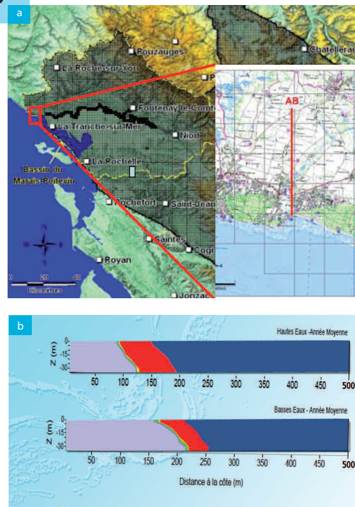
Figure 4. Avancée du biseau salé pour différents scénarios de remontée océanique sur un transect du Marais Poitevin (Le front équivalait à une concentration de 100 mg.L -1 de chlorures).
