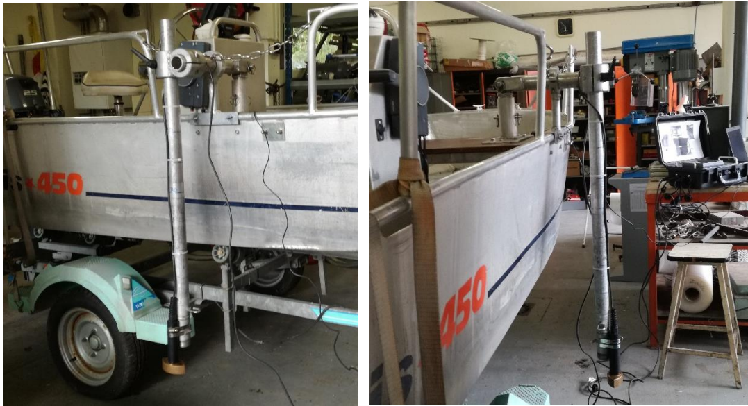
Figure 6 : Montage assurant l'horizontalité du transducteur
