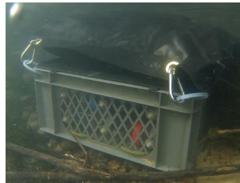
Figure 7 : Système d'immersion contenant les cages de gammares
