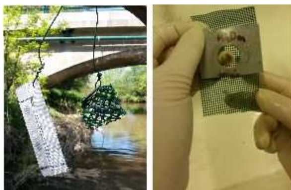
Figure 35 - Substrats artificiels pour mesurer la décomposition microbienne.
