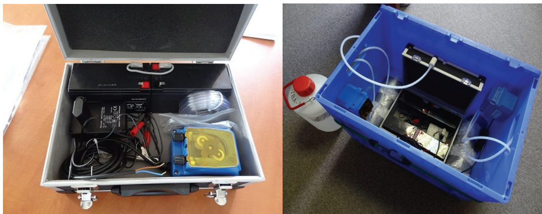
Figure 29. Système de prélèvement des eaux dans le ruisseau du Bourg par temps de pluie. © SIBA.
