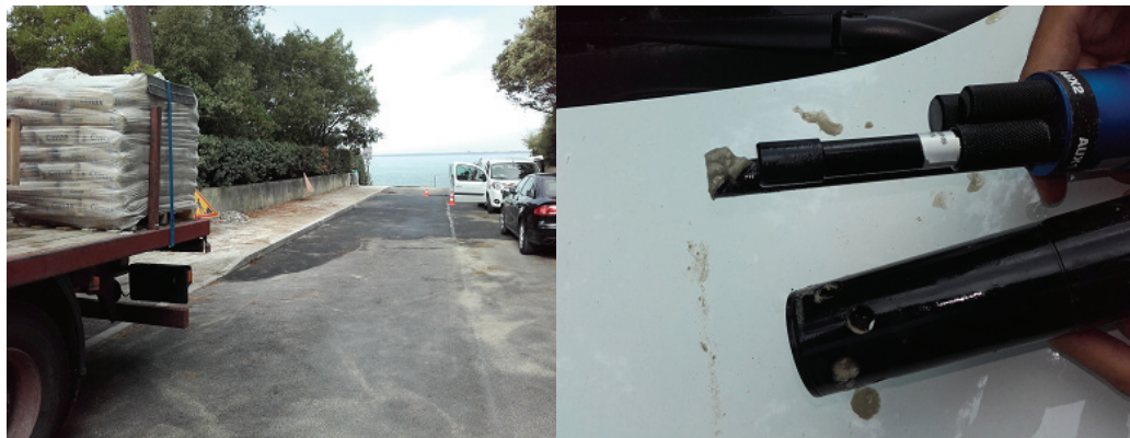
Figure 63. Infiltration de ciment dans le piézomètre aval suite à un chantier, et encrassement subséquent de la sonde.
