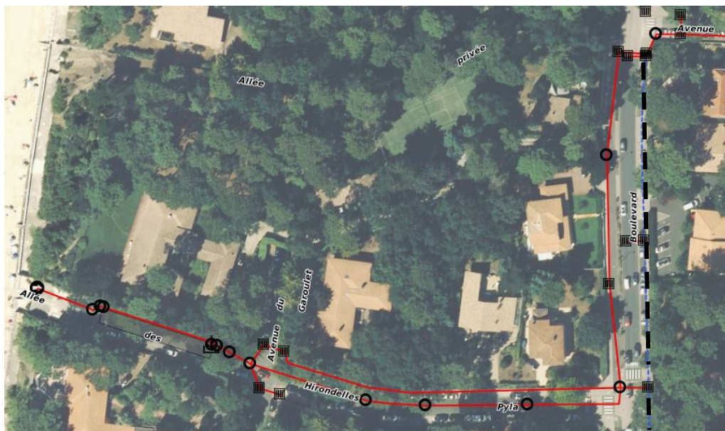
Figure 54. Réseau pluvial au niveau du bassin versant des Hirondelles. En rouge, le réseau pluvial qui achemine les eaux pluviales au bassin d'infiltration des Hirondelles. En noir pointillé, la tranchée drainante qui récupère les eaux de la route départementale.
