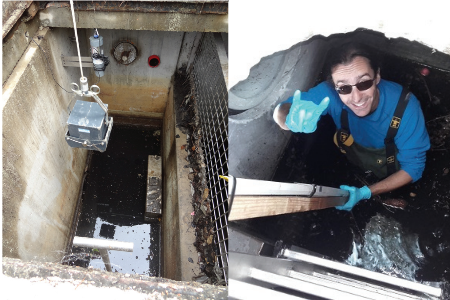
Figure 22. Prélèvements de sédiments de décantation au niveau du bassin d'infiltration de Reinhard (commune de Lège-Cap-Ferret), à gauche ; et mesure de la hauteur de sédiment, à droite. © SIBA.
