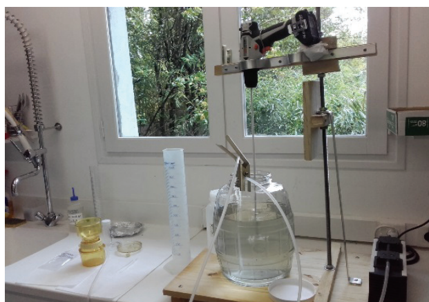
Figure 77. Système d'homogénéisation des échantillons d'eau pluvial avant prélèvement des aliquotes.
