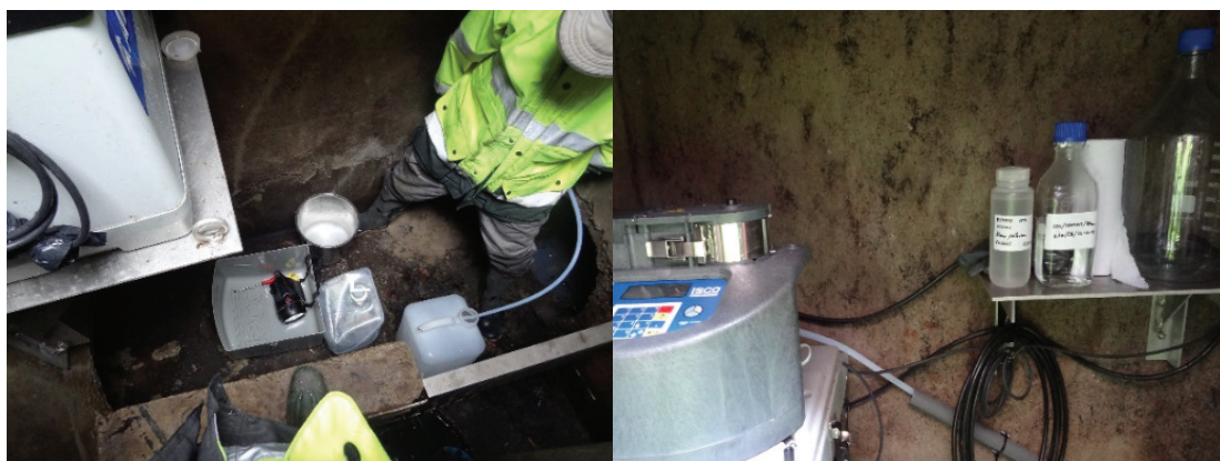
Figure 76. Procédure de nettoyage et réalisation des blancs de prélèvement sur site.
