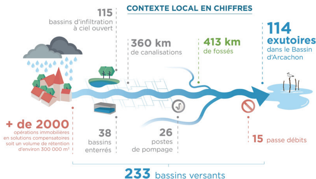
Figure A. Schéma de principe des solutions compensatoires implantées sur le réseau d'eaux pluviales en protection du Bassin d'Arcachon.
