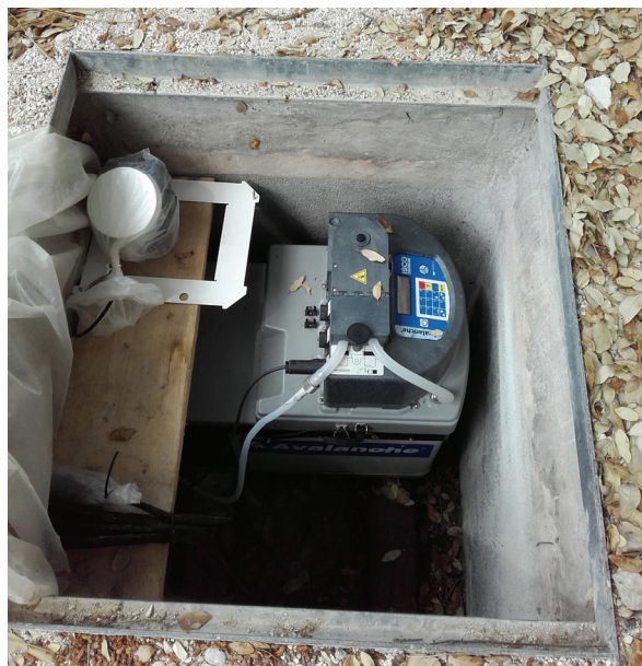
Figure 17. Préleveur automatique installé dans le regard aménagé dans la voirie. © SIBA.
