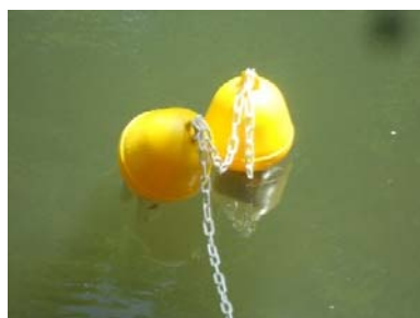
Figure 68: Système de déploiement de type « bouée » privilégié pour les grands cours d'eau
